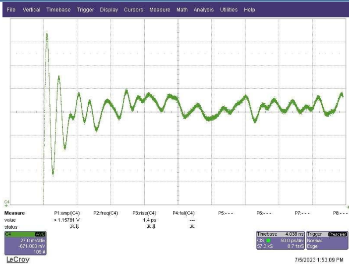
图23: 图22中的测量系统获得的ULBA4863顶部平坦度 (2%/div)。
