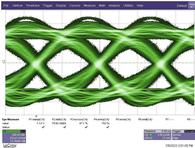
图8: 图7 中的测量系统获得的ULBA4863放大后输出眼图。
