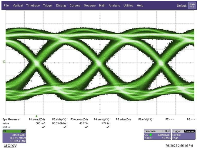
图9: 图7 中的测量系统获得的M827B放大后输出眼图。
