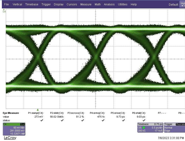
图33: 使用SE-70采样器在WaveExpert示波器上测量的来自DAC4的56Gbps特殊应力模式。
